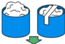
スプレー缶を平らな場所に置き、キャップを逆さまにしてキャップの窪みに合わせキャップを押し込みます。**※中身が残っている場合は、ティッシュを数回交換して中身を抜いてください。**
